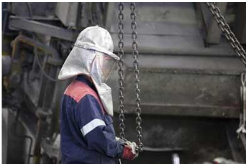
Die sogenannte Giesshaube schützt vor Spritzern flüssigen Metalls.
